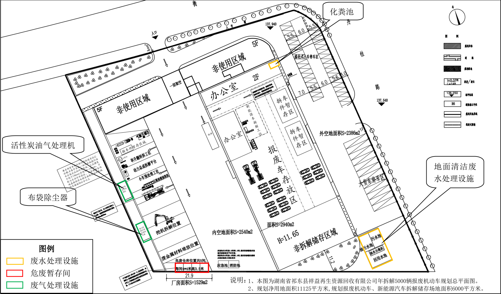
附图 2：总平面及环保设施布局图
