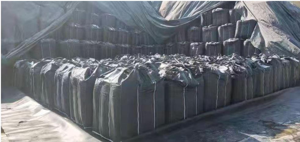
图 3.6-1 固化飞灰堆砌现场照片
